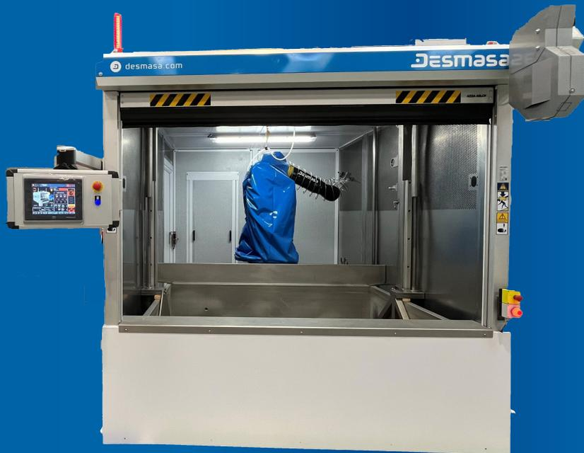
Las células robotizadas de corte 3D de la serie WJn aúnan la dilatada experiencia en automatización, robótica y alta presión de DESMASA, ofreciendo una solución integral al proceso [Célula, Intensificador HP, Software, Programación, Periféricos,...]
